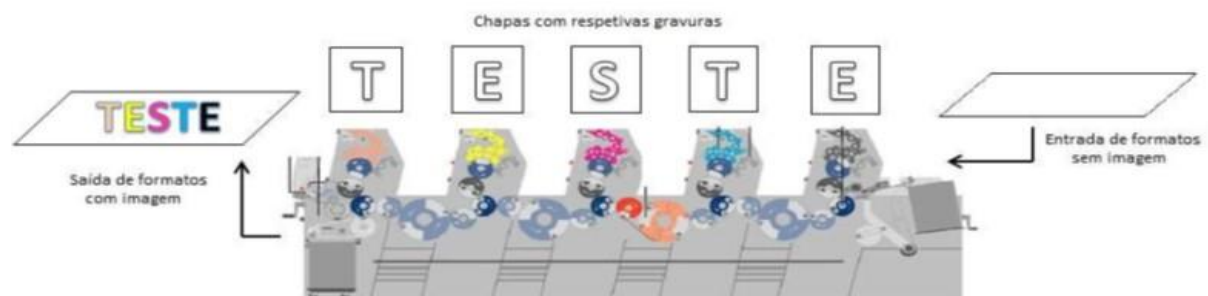
Figura 19 - Esquemática de uma Máquina de Impressão Offset (Passos, 2013)
