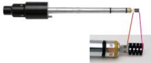
Figura 22 - Ponta onde se colocam as amostras dum porta-amostras de 4 posições. (“JEM-1400Plus Electron Microscope,” n.d.)
