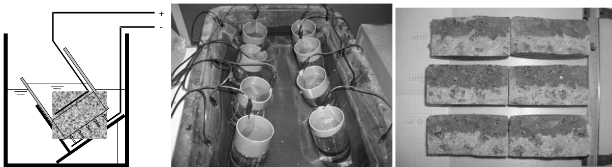
Figura 2 – Migração de cloretos (LNEC E463:2004).
