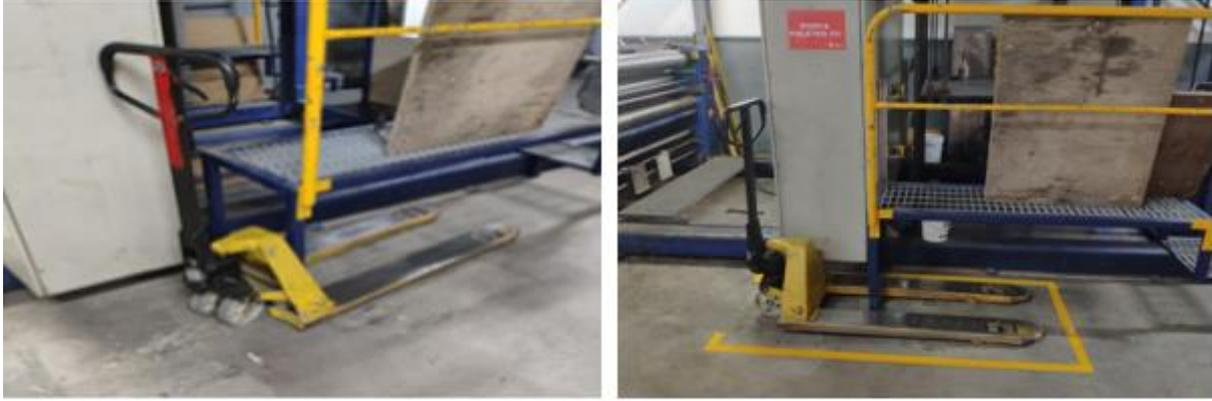
Figura 60 - Antes e depois da identificação da zona de armazenamento do porta-paletes, à esquerda e direita, respetivamente
