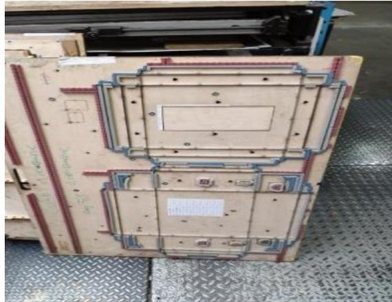
Figura 21 - Exemplo de um cortante
