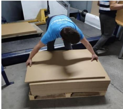
Figura 47 - Operador a preparar palete para abastecer a máquina CC3
