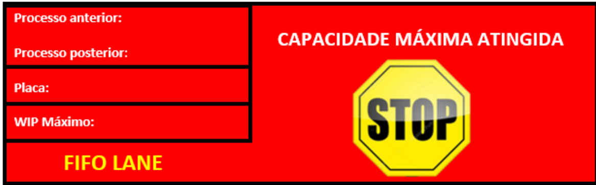
Figura 29 - Cartão indicador da capacidade máxima da FIFO LANE
