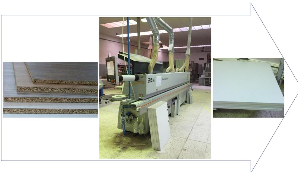
Figura 26 - Material de entrada na Orladora, Orladora e placas com as orlas colocadas
