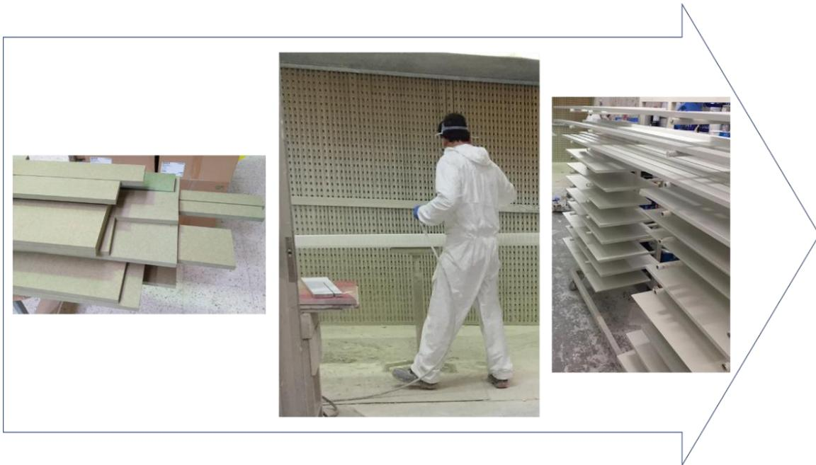
Figura 29 - Material pronto para pintura, fase de pintura e produto lacado
