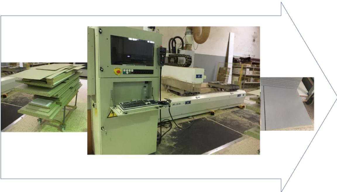
Figura 25 - *Input* da CNC, execução do trabalho e respetivo *output*
