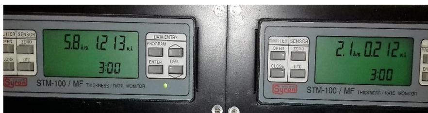
Figura 3.6-Monitores dos sensores de espessura.
