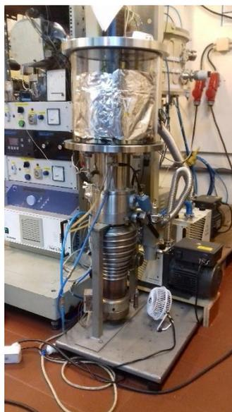
Figura 3.1-Câmara de vácuo para a co-evaporação térmica dos filmes de  $\text{Sb}_2\text{Te}_3$  e  $\text{Bi}_2\text{Te}_3$ .
