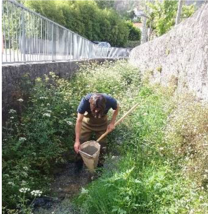
Figura 2 - As redes são utilizadas no processo de amostragem para avaliar a saúde biológica dos rios.
