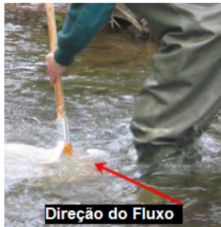
Figura 3 - Posição da rede de mão para realizar a amostragem (Freshwater Biological Association: http://www.fba.org.uk/sites/default/files/CourseInvertSamplingProtocol.pdf ).
