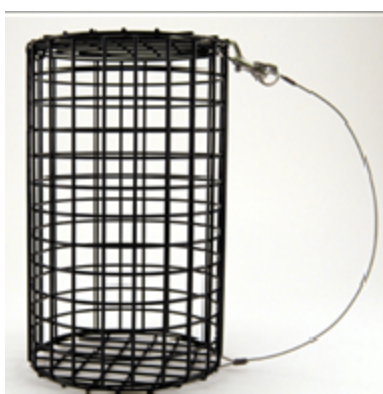
Figura 5 - "Basket sampler" para amostragem dos macroinvertebrados aquáticos em rios profundos (Clapcott et al., 2012).
