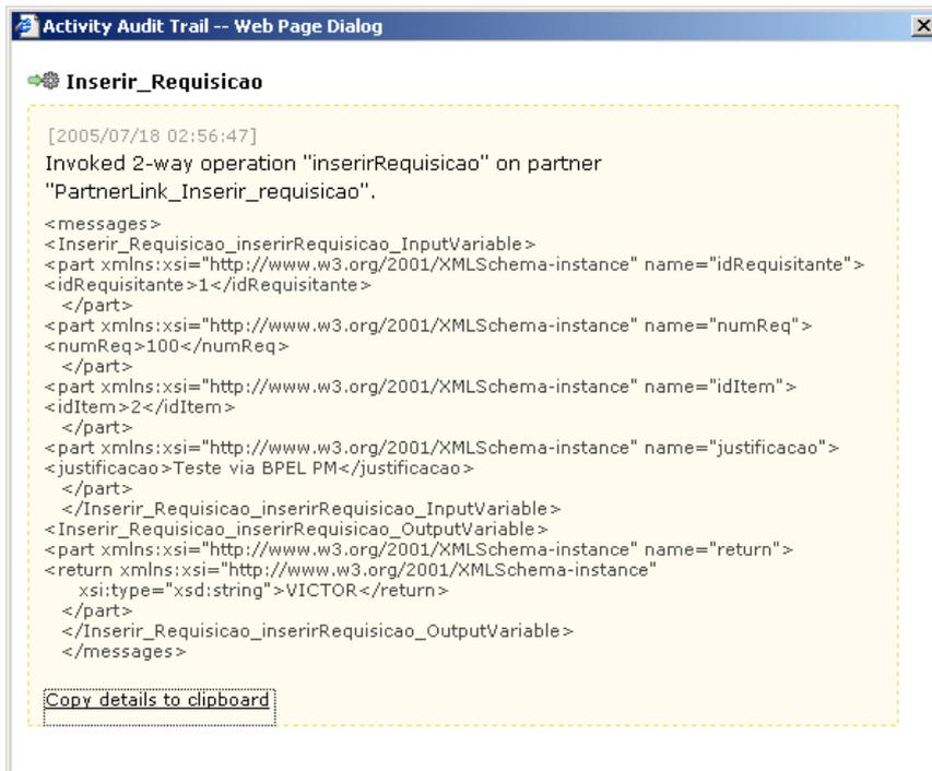
Figura 5.61: XML na invocação do Web Service “Inserir\_Requisicao” para a requisição nº100
