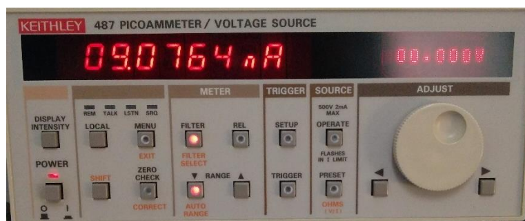
Figura 6.2 – Valor de corrente à saída do fotodetetor utilizando uma amostra de referência (água do mar filtrada).
