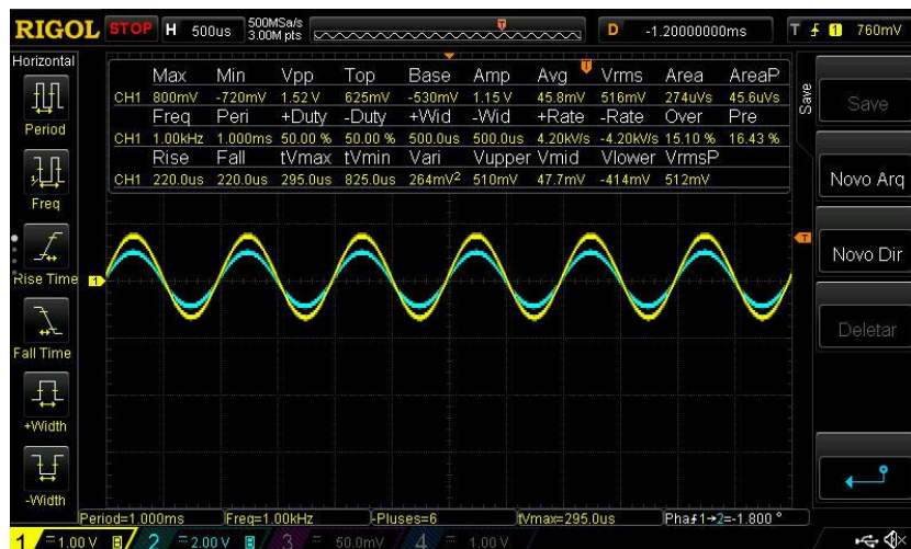
Figura 5.25 – Sinal do amplificador (amarelo) e da referência (azul) à entrada do multiplicador após correção do desfasamento.
