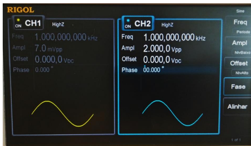
Figura 5.11 – Configuração do sinal de entrada no channel 1 e do sinal de referência no channel 2 .
