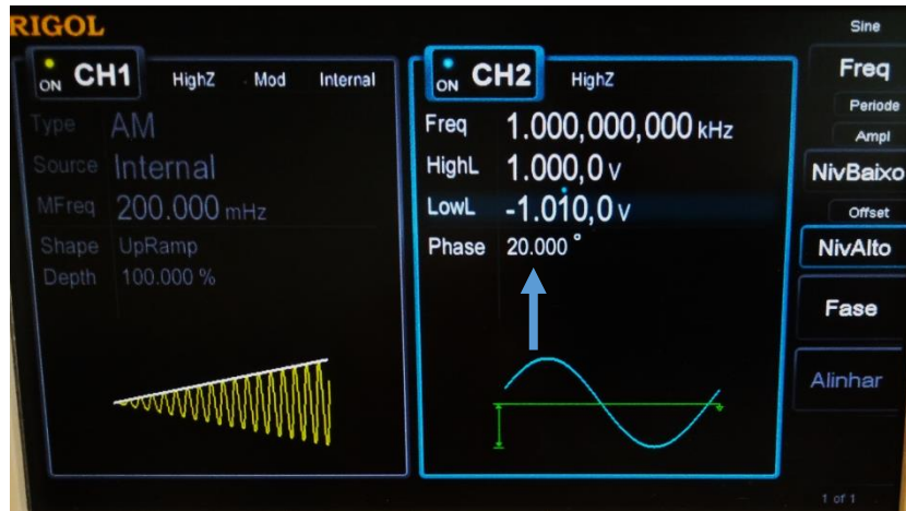
Figura 5.24 – Correção da fase sinal de referência no gerador de sinais.
