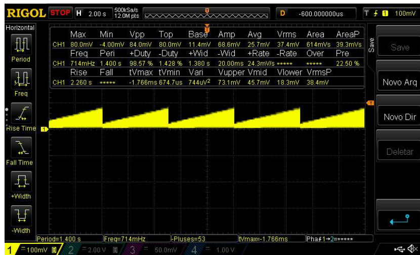
Figura 5.26 – Sinal obtido à saída do multiplicador após correção da fase.
