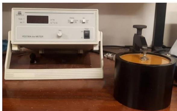
Figura 3.9: Equipamento  $d_{33}$ -meter utilizado para a medição do coeficiente piezoelétrico  $d_{33}$ .
