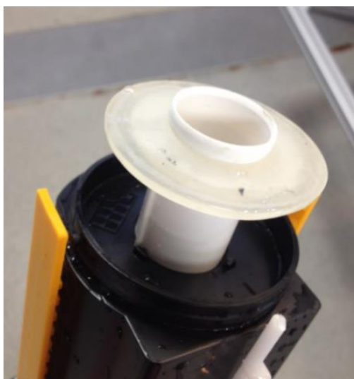
Figura 28- Vedante em TPE após 200 mil ciclos
