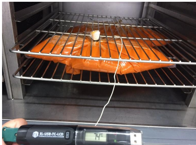
Figura 6 - Colocação da sonda, ligada ao datalogger LASCAR EL US, no interior do saco de 4,5 kg de molho, para verificação do arrefecimento do produto após processamento.
