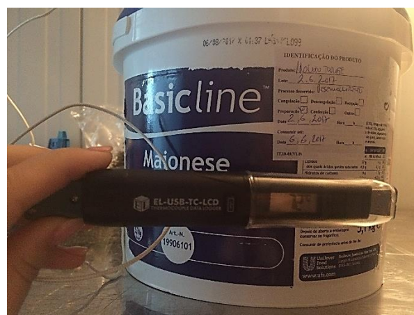
Figura 5 - Colocação da sonda, ligada ao datalogger LASCARELUS , no interior do balde, contendo o molho de tomate, para verificação do arrefecimento do produto após processamento.
