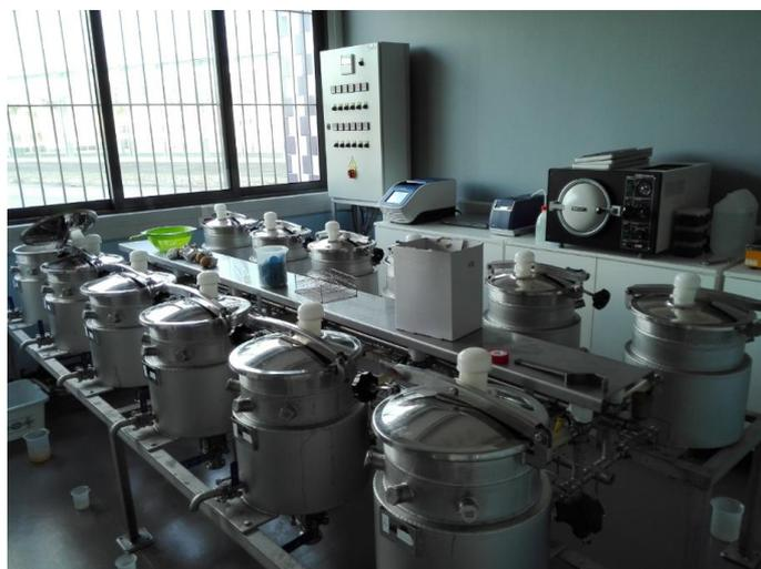
**Figura 15** – Estação piloto constituída por 12 fermentadores, revestidos com uma camisa de arrefecimento cuja temperatura é controlada por um *chiller*.
