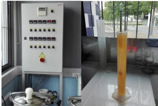
**Figura 17** – Na esquerda o *chiller* que controlava as temperaturas das cubas e a imagem da direita o aerómetro mergulhado na proveta com uma amostra de um mosto e fermentação para ler a massa volúmica.
