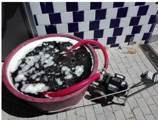
**Figura 16** – Dorna de 250 L e a bomba de água utilizados para diluir o mosto para distribuir nas cubas.
