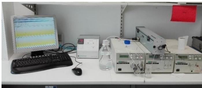
**Figura 18** – Sistema de Cromatografia de Líquidos (HPLC), usado para a quantificação da glucose, da frutose, do etanol, do glicerol, do ácido málico, do ácido cítrico, do ácido tartárico e do ácido succínico.
