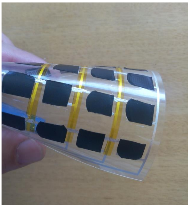
Figura 22: Flexibilidade apresentada pela matriz de sensores térmicos produzida por tecnologia de impressão
