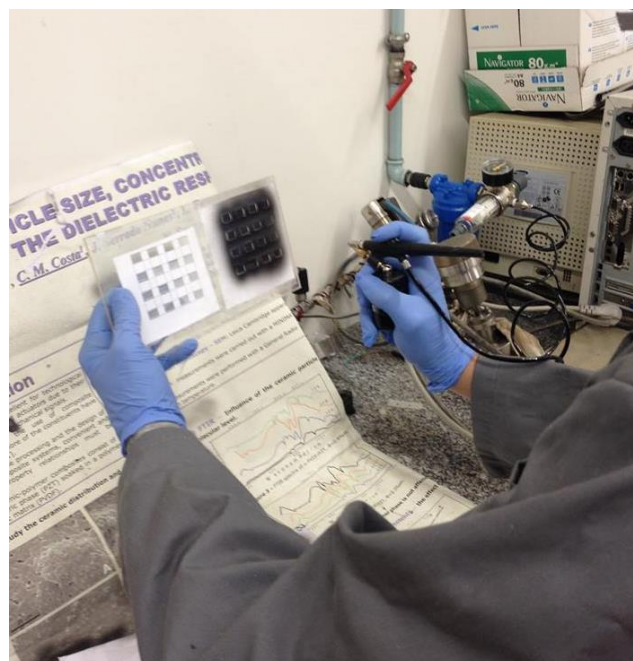
Figura 19: Deposição da pasta termoelétrica por spray printing
