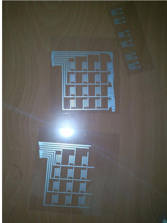
Figura 21: Circuitos em tinta de prata impressos por screen printing
