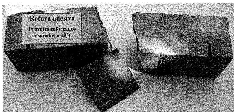
Fig. 6 – Rotura tipo adesiva dos provetes reforçados e ensaiados a 40°C.
