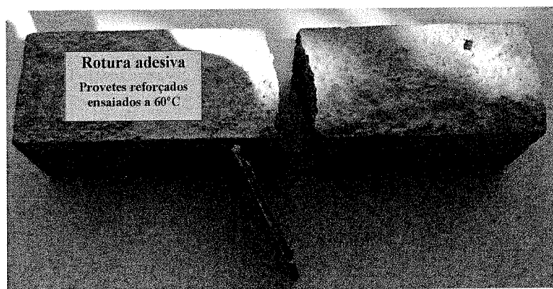
Fig. 7 – Rotura adesiva tipo dos provetes reforçados e ensaiados a 60°C.
