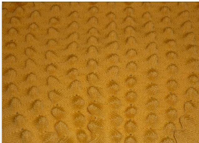
Figura 10: Malha de trama com efeito 3D Egg Nest desenvolvido pela Shima Seiki. Fonte: Ionesi, 2010.
