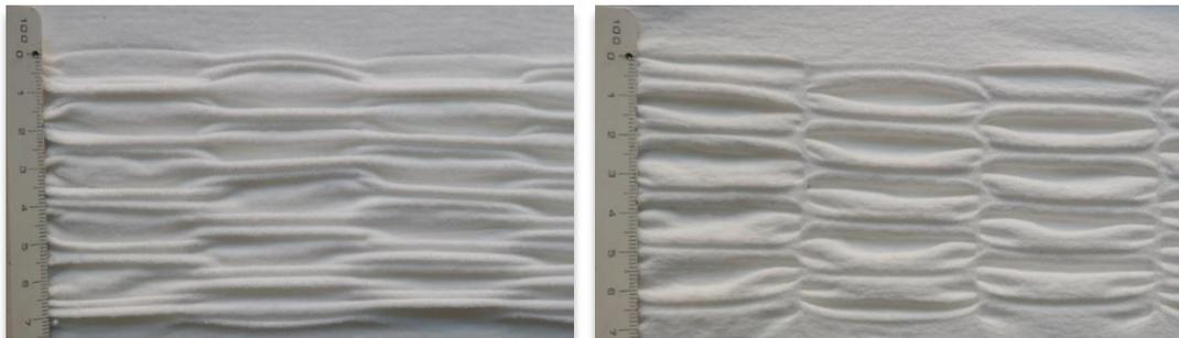
Figura 50: Avesso e direito técnico da malha H2 resultante do método de criação de estrutura por inserção de bitmap em Fio Branco Poliamida 100%.
