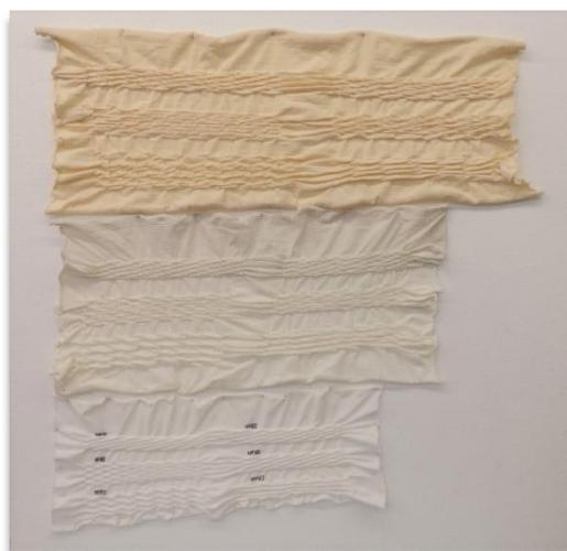
Figura 45: Diferença de altura e largura do tubo em amostras com mesmas estruturas, mas fios diferentes.
