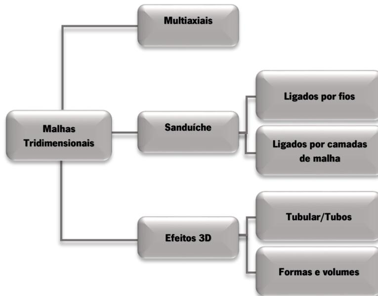
Figura 8: Tipos de malhas tridimensionais. Fonte: Pires (2014) adaptado de Ionesi (2010).
