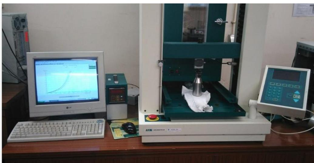
Figura 55: Dinamômetro Hounsfield com célula de carga de 250N.
