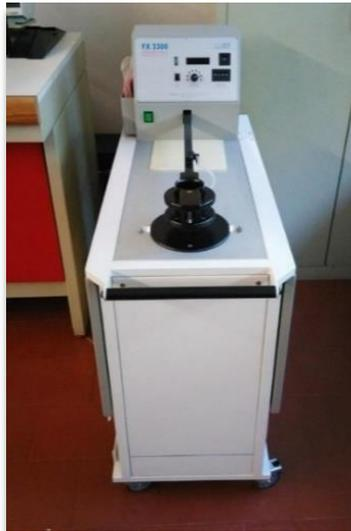
Figura 58: Instrumento Textest FX 3300 para medição de permeabilidade ao ar.
