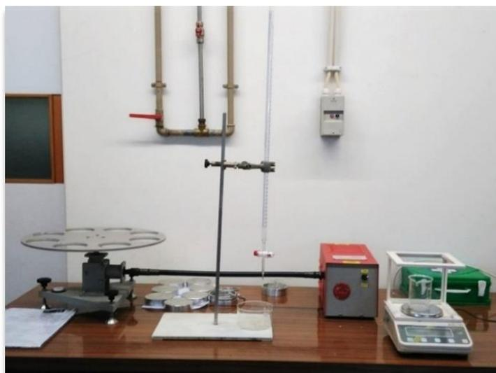
Figura 61: Permeabilímetro de vapor de água *Shirley Water Vapour Permeability Tester M261*.
