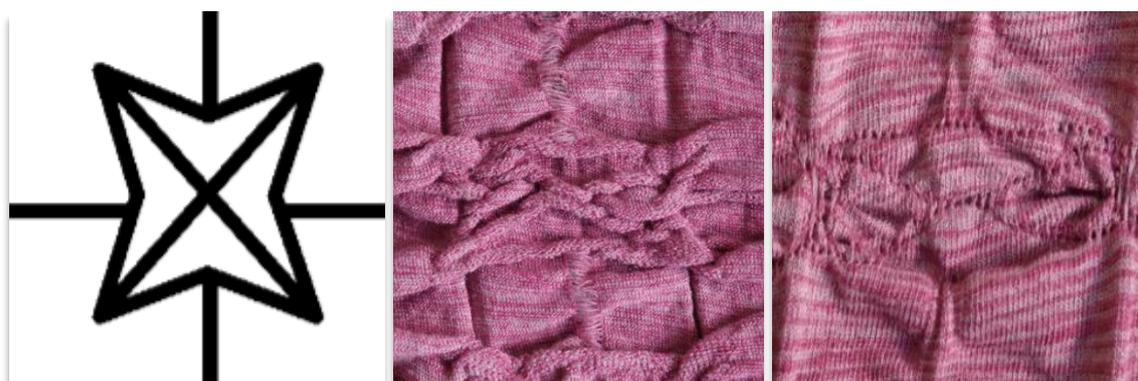
Figura 44: Desenho de estrutura inserida como bitmap e efeito na malha tricotada (avesso e direito técnico).
