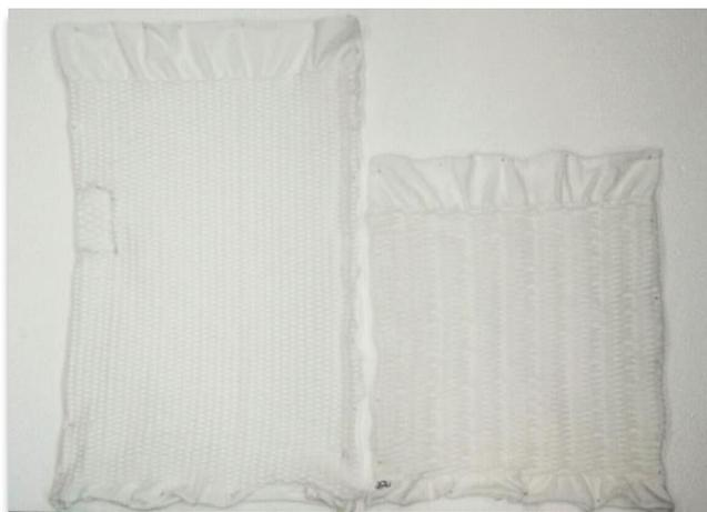
Figura 52: Diferença de altura e diâmetro de pano das amostras H2 e H2G tricotados em Fio Branco Poliéster 100%..
