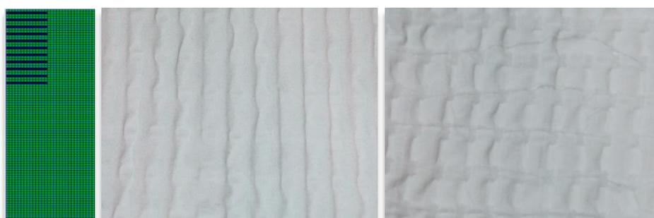
Figura 71: Variação da malha H2B (canais na vertical) - desenho na célula estrutural de ponto (64x32) e feito na malha tricotada em Fio Branco de Poliamida 100%.(direito e avesso técnico).
