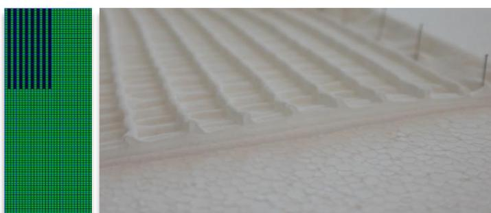
Figura 70: Variação da malha H2B (canais na horizontais) - desenho na célula estrutural de ponto (64x32) e efeito na malha tricotada em Fio Branco de Poliamida 100% (avesso técnico).
