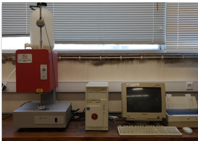
Figura 53: Medidor de Espessura Digital *Thrickness Gauge M034A*.
