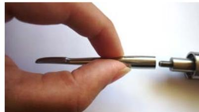
Fig. 7 Mecanismo de rosca para fixação da ponta ativa
