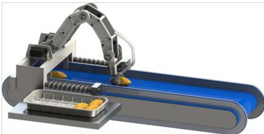
Figura 16: Solução conceptual inovadora quando no início da função pegar
