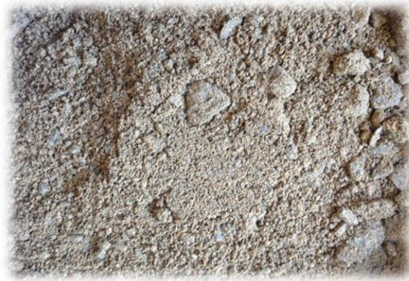
Figura 3.1 - Agregado britado de granulometria extensa utilizado nas misturas
