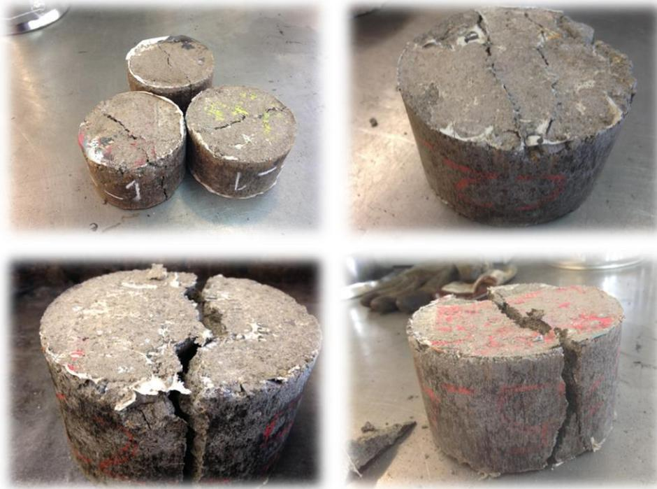
Figura 3.13 - Diferentes tipos de fissuras obtidas no ensaio de tração indireta para vários tempos de cura
