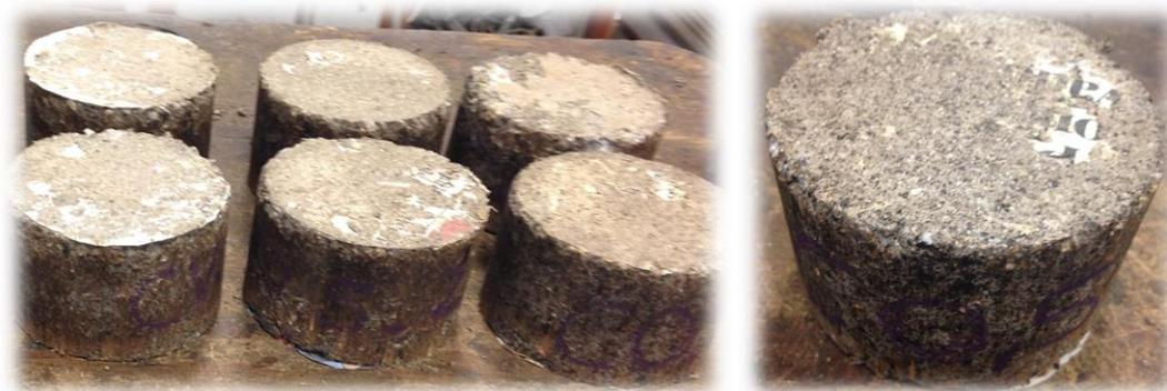
Figura 3.7 – Aspeto final de alguns provetes produzidos com ABGE tratado com emulsão
