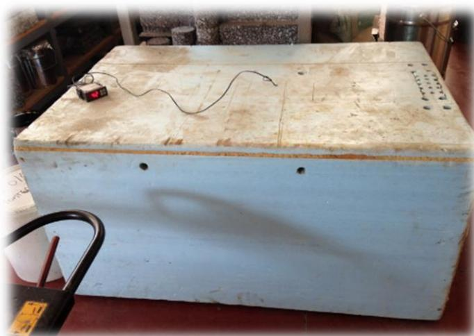
Figura 3.11 - Estufa utilizada para colocar os provetes a 40 °C
