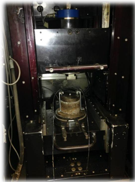
Figura 3.14 - Equipamento utilizado para realizar o ensaio de resistência à compressão uniaxial cíclica
