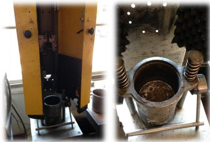
Figura 3.6 - Compactador utilizado na realização dos provetes
