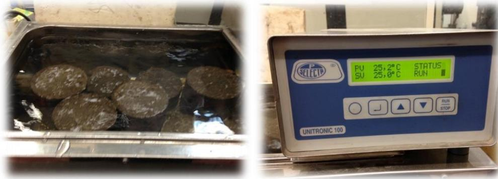
Figura 3.9 - Provetes imersos em água a 25 °C para o ensaio de sensibilidade à água
