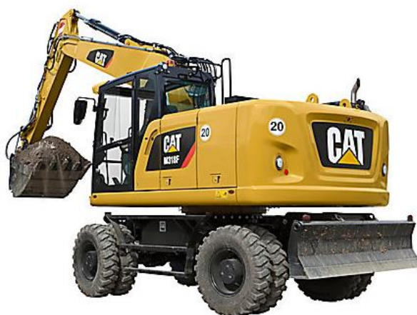
Figura 39 - Retroescavadora utilizada na realização dos ensaios dinâmicos de colisão
