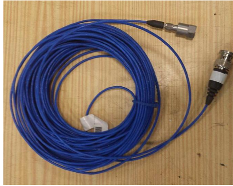
Figura 46 - Acelerómetro de 50 g proposto utilizar numa segunda campanha de ensaios
