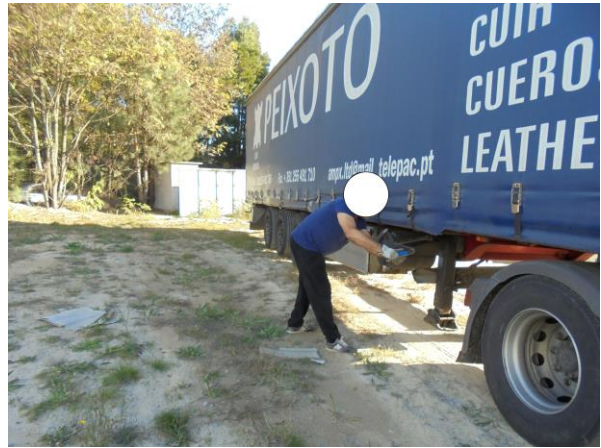
Figura 7 - Camionista a despertar as cintas da galera
