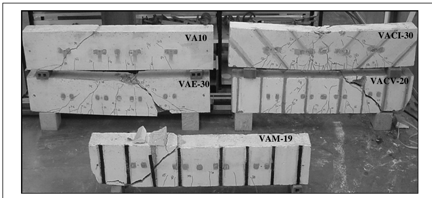
Figura 8 - Modos de rotura das vigas da série A com 4φ10 longitudinais.
