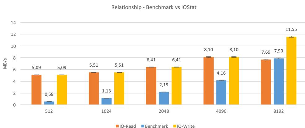
Figura 83 - Ensaio de escrita aleatória ao disco SSD sem a técnica de write-caching ativa e em modo raw. Relação entre os dados de IO da ferramenta de benchmark e da ferramenta IOSTAT.
