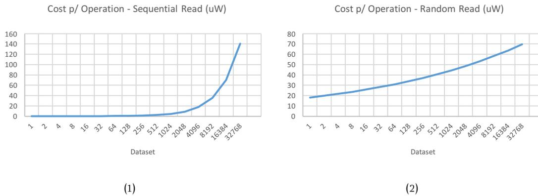
Figura 129 - Gráficos obtidos através de fórmulas geradas pela ferramenta *CurveExpert* a partir dos dados obtidos nos ensaios do disco SSD. Custo por operação de leitura sequencial (1) e de leitura aleatória (2).
