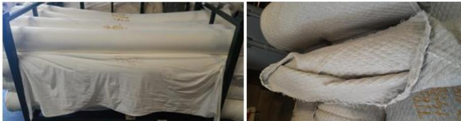
*Figura 29 – Malha aberta (esquerda) e malha em manga (direita)*
