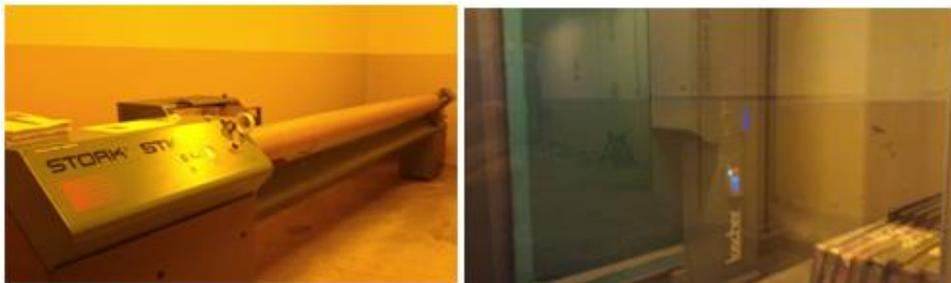
Figura 35 - Máquina de gravura do desenho em rolo (esquerda) e máquina de gravura em quadro (direita)
