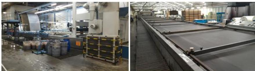
*Figura 37 - Máquina de estampagem: a rolos de 12 cores (esquerda) e quadros de 12 cores (direita)*
