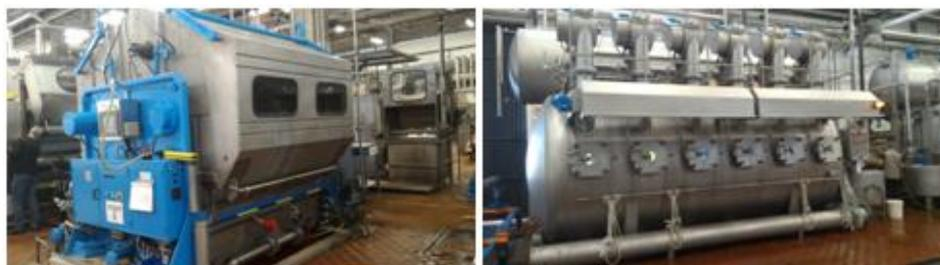
Figura 33 – Jigger (esquerda) e Jet (direita)
