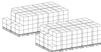
Figura 4 - Sistema de armazenamento em bloco (Fonte: Gleissner e Femerling, 2013)
