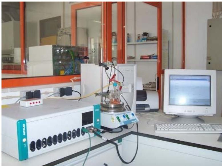
Figura 31 Sistema voltamétrico usado.
