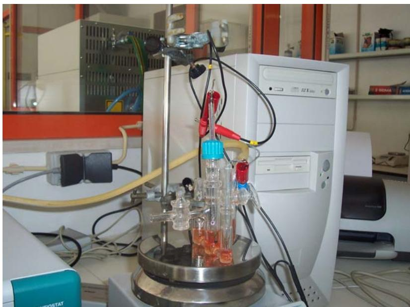
Figura 32 Célula electroquímica.
