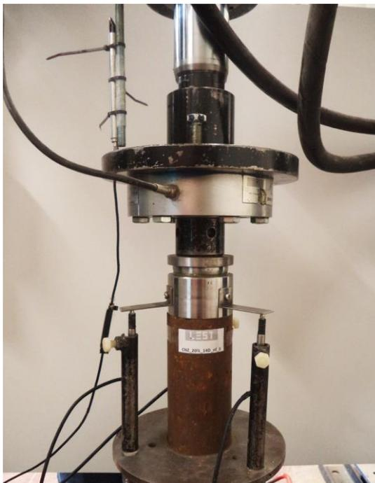
Figura 48- Posicionamento dos sensores internos e do sensor externo para medição dos deslocamentos durante o ensaio de compressão uniaxial
