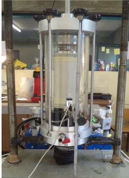
Figura 30- Ensaio triaxial: Medição dos deslocamentos ocorridos no provete com o auxílio de um LVDT externo
