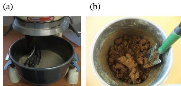
Figura 41- Preparação das misturas: (a) Mistura dos elementos da fase sólida; (b) Junção da fase sólida com a fase líquida das misturas ativadas alcalinamente
