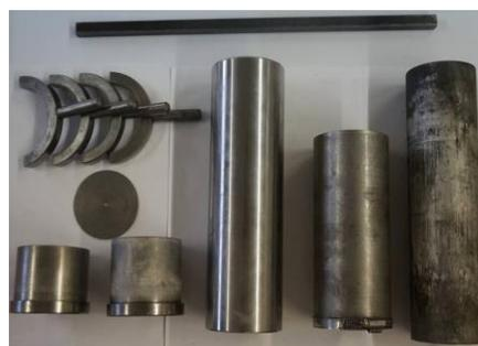
Figura 42- Equipamentos utilizados para fabrico dos provetes: Molde cilíndrico, alonga e tampas
