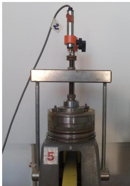
Figura 27- Ensaio edométrico: Medição dos deslocamentos com auxílio do LVDT
