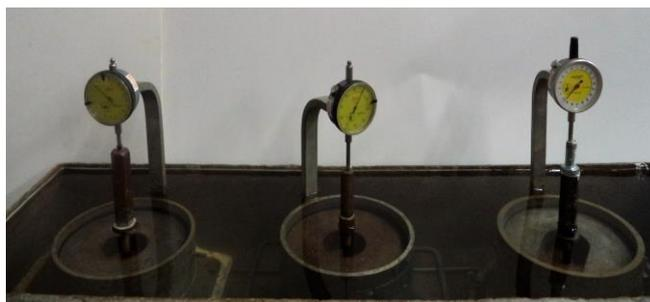
Figura 71- Provetes em embebição: CAL\_10%, CNZ\_20%\_nf e CMT\_10%
