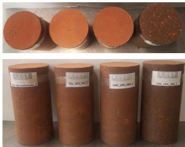
Figura 44- Diferença de coloração dos provetes conforme a composição da mistura: Solo\_não\_melhorado, CAL\_10%, CMT\_10% e CNZ\_15%
