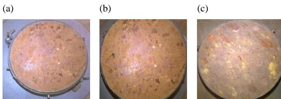
Figura 34- Molde Proctor compactado: (a) Mistura de solo com 7,5 % de cal; (b) Mistura de solo com 7,5% de cimento; (c) Mistura de solo com 15% de cinzas volantes
