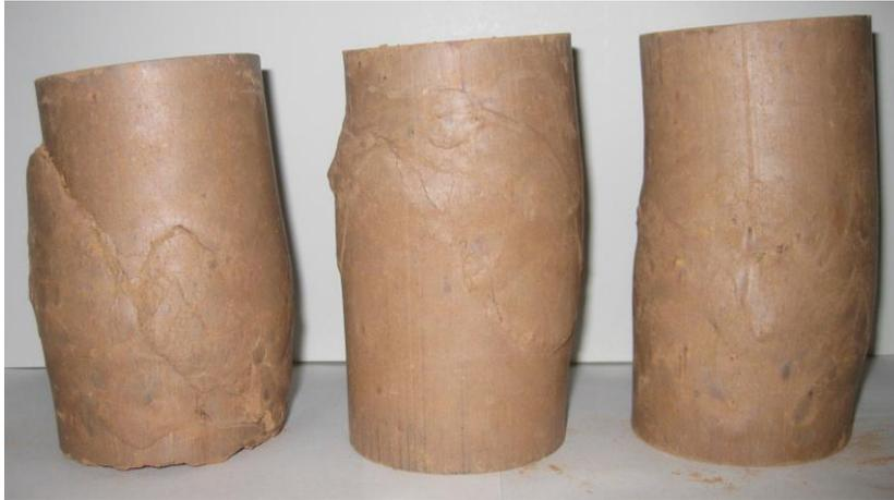
Figura 33- Aspeto final dos provetes de solo natural
