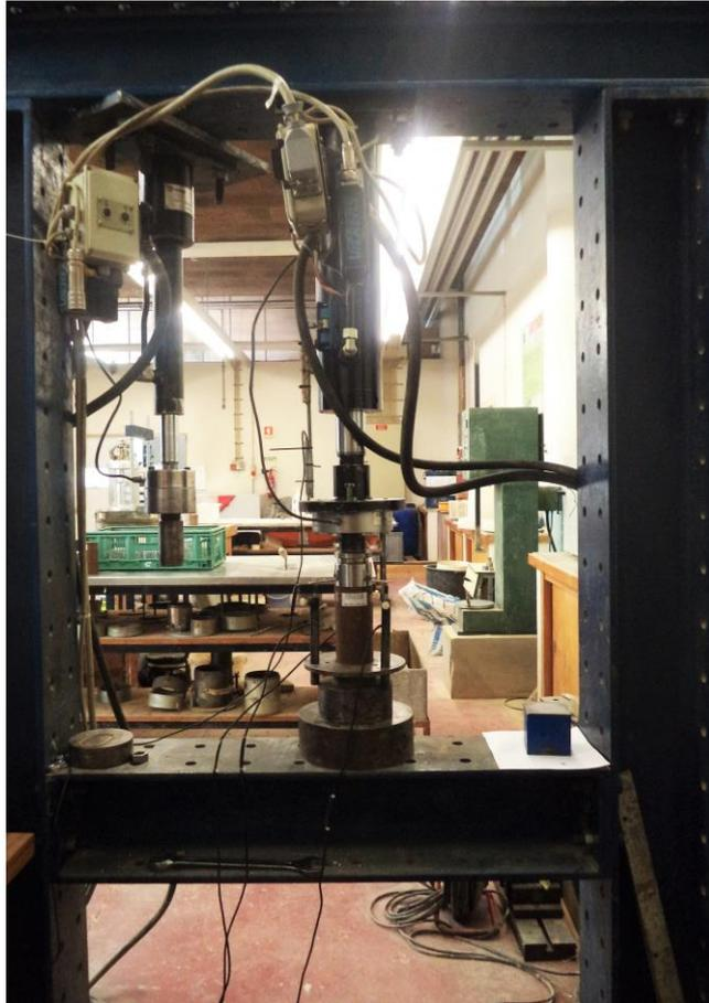
Figura 47- Pórtico equipado com atuador com célula de carga de 25 kN ou 100 kN
