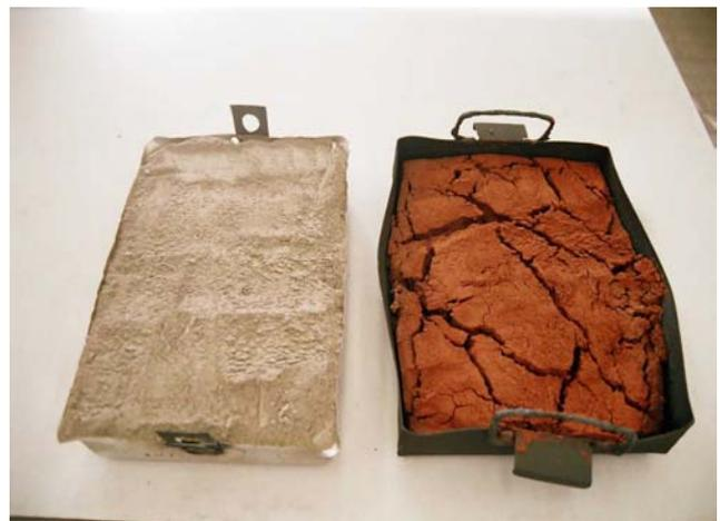
Fig. 1. Tratamento térmico das lamas residuais.
