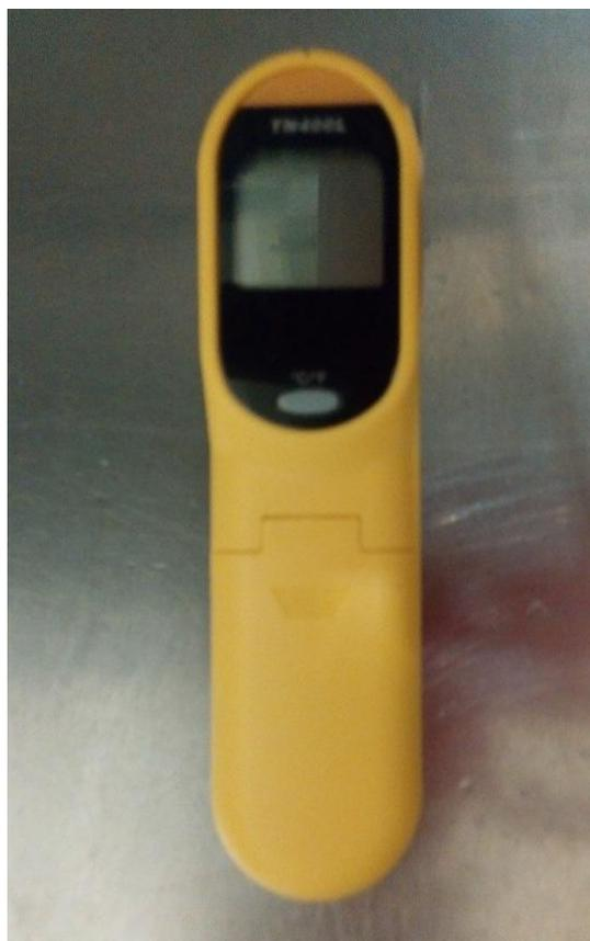
Figura 10: Termómetro de Infravermelhos utilizado na verificação da temperatura de chegada dos produtos refrigerados.
