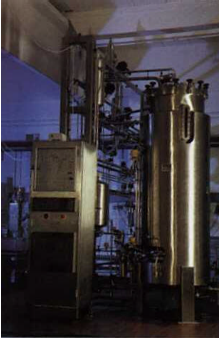
Figura 6. Bioreactor convencional para produção de NEPs à escala piloto.
