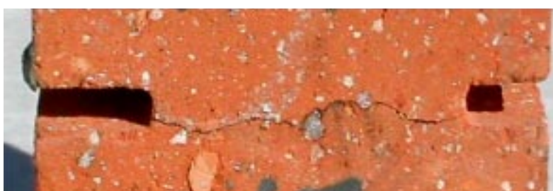
Trazione monoassiale su un elemento di laterizio con intagli precostituiti.
