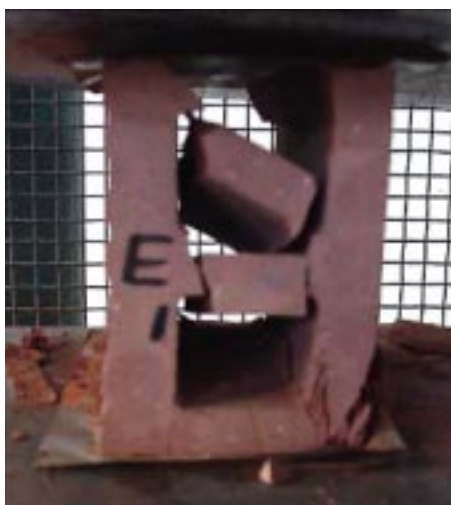
Compressione monoassiale su un campione intero di laterizio, con facce rettificata.
