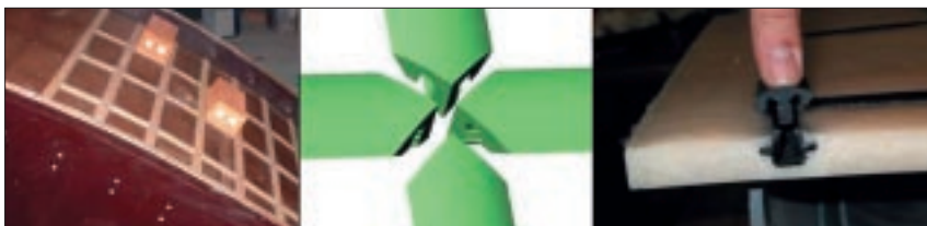
Procedimenti alternativi per mantenere in posizione i laterizi durante la confezione dei pannelli.
