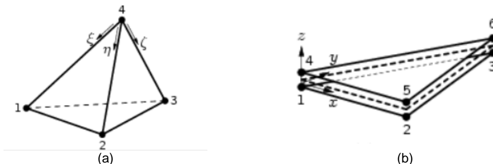
Figura 5 - Tipo de elementos finitos utilizados no modelo numérico; (a) elementos para a argamassa e tijolos; (2) elementos de interface para representar a ligação entre o ligador e a argamassa
