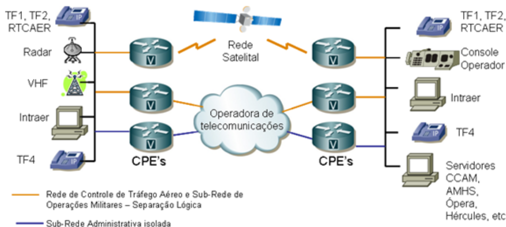
Figura 7 - Topologia da rede de controle do tráfego aéreo e da sub rede de operações militares
