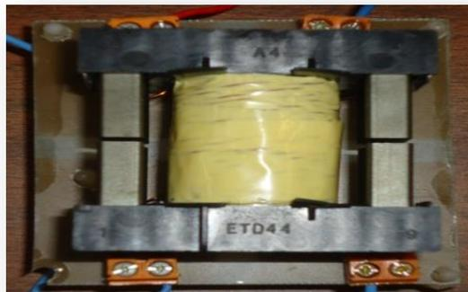
**Figura 4.4- Transformador de alta frequência.**
