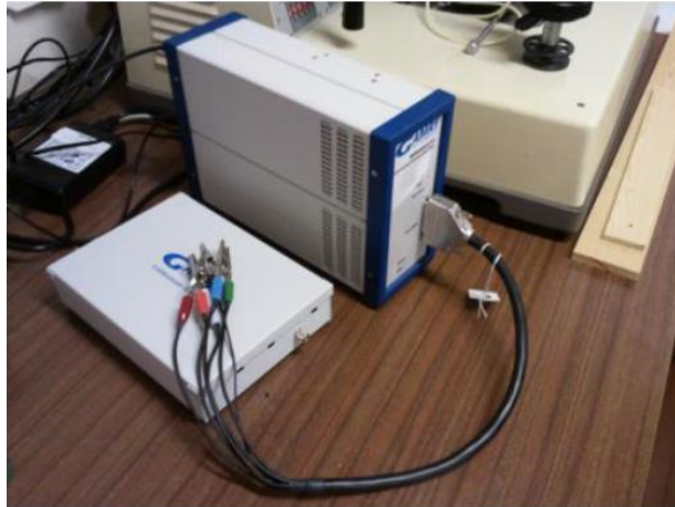
Figura 4-2 -Gamry 600, aparelho utilizado para a realização dos testes de condutividade
