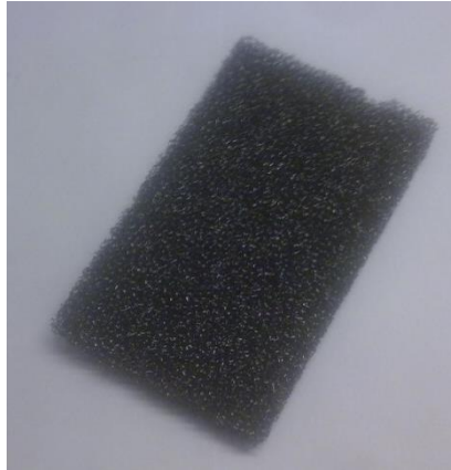
Figura 3-9- Carbono usado nos elétrodos usados nos testes realizados - 45 poros por polegada
