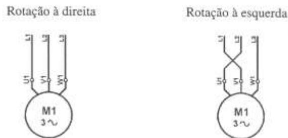
Figura 82 - Esquema de inversão de rotação de um motor trifásico [Anexo A]
