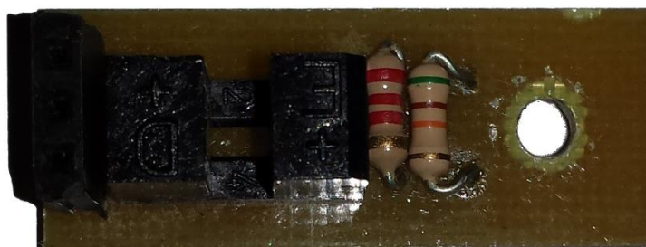
Figura 43 - Placa de circuito impresso desenvolvida para suportar os sensores óticos.
