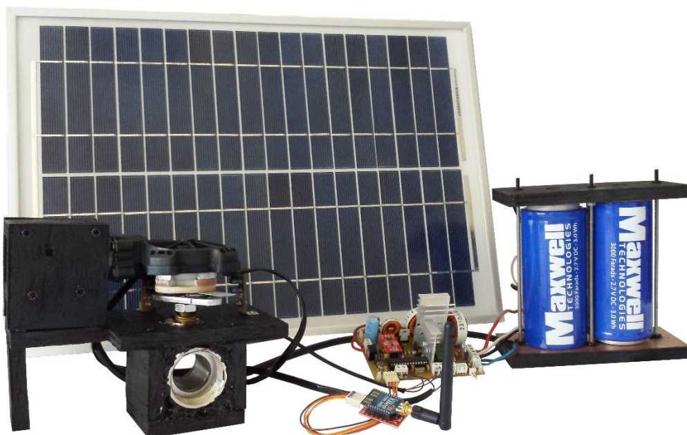
Figura 82 - Sistema testado durante o uso do módulo de ultracondensadores como elemento armazenador de energia.
