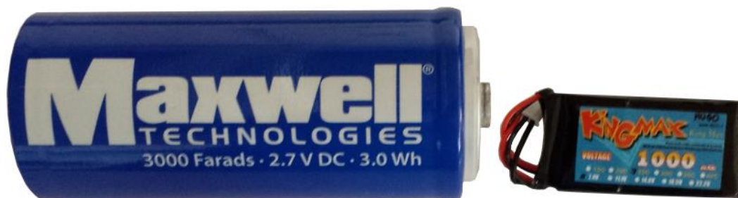
Figura 57 - Ultracondensador de 3000 F, 2.7 V e bateria de 7.4 V, 1000 mAh.
