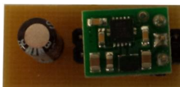
Figura 78 - Placa responsável por manter a alimentação do controlador estável em 5 V quando se usa o módulo de ultracondensadores como elemento armazenador de energia.
