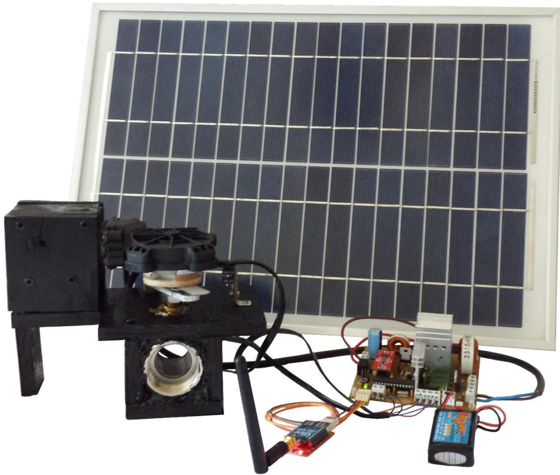
Figura 88 - Sistema testado durante o uso da bateria como sistema armazenador de energia.
