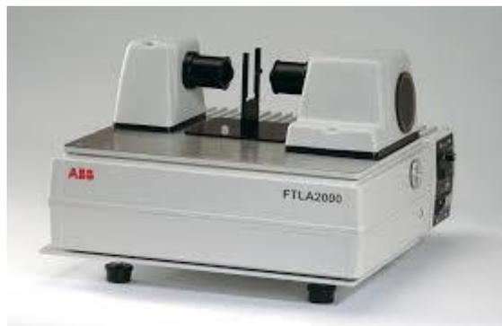
Figura 2.3 – Aparelho de FTIR utilizado neste trabalho.
