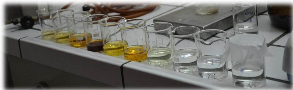
**Figura 2.2** – Diferentes frações orgânicas após a realização de uma cromatografia “flash”.
