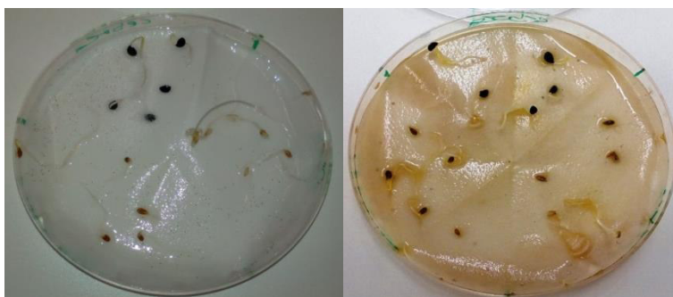
Figura 3.13 - Réplica de um branco de controlo, e de um extrato num teste de germinação com sementes de cenoura, alface e cebola após 24 h de ensaio.
