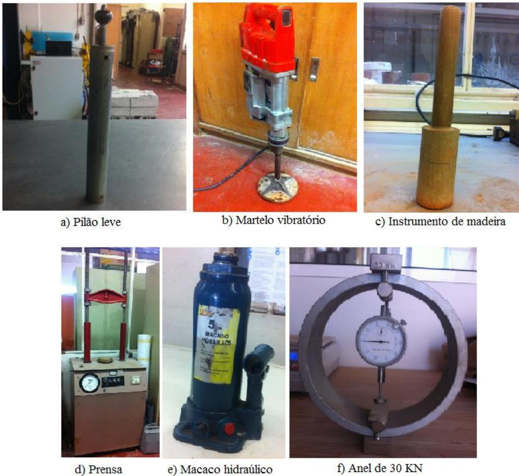
Figura 20- Equipamentos utilizados e disponíveis no laboratório de Geotecnia da Universidade do Minho, na realização de cada técnica de compactação em estudo
