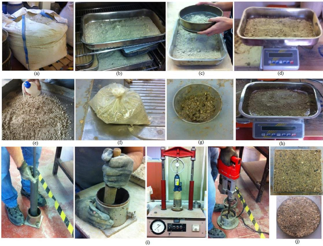
Figura 22- Processo seguido para preparação das amostras para ensaio
