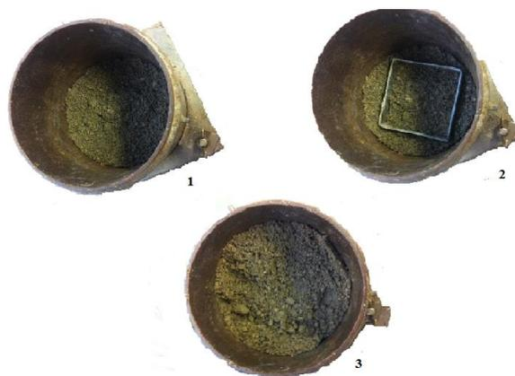
Figura 23- Processo de compactação de uma camada de solo
