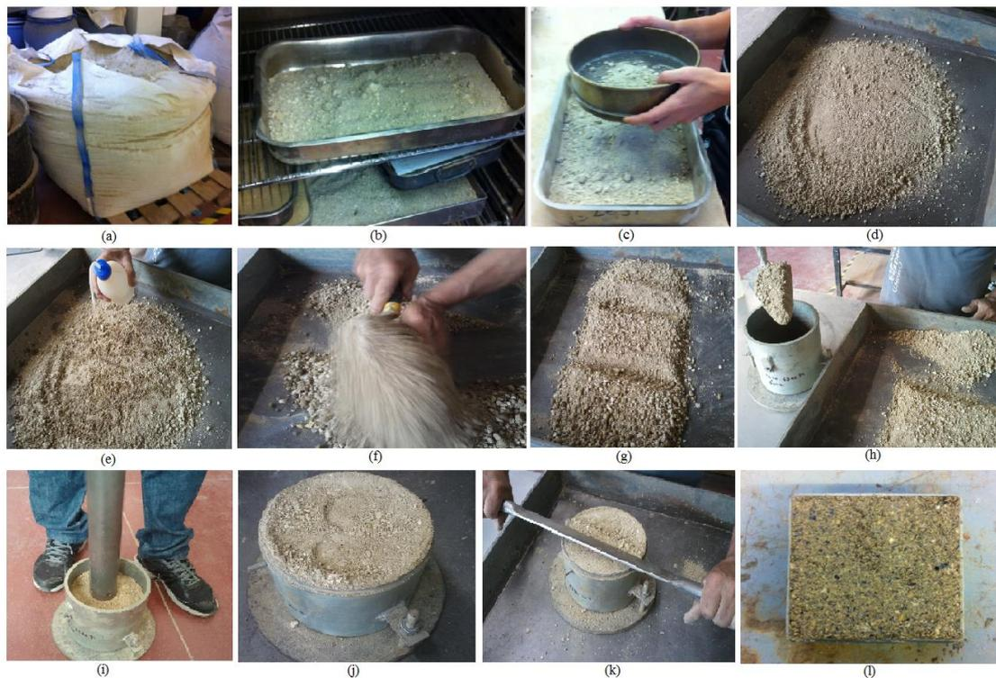
Figura 21- Procedimento seguido para determinação do peso volúmico através da compactação Proctor leve
