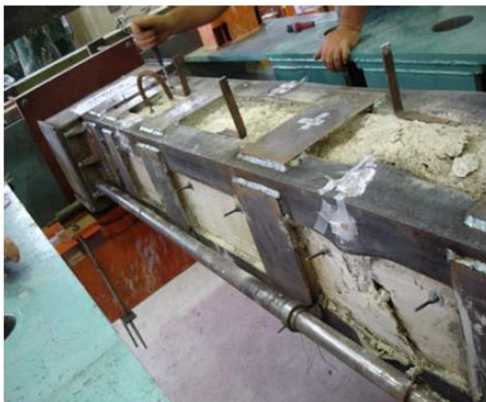
Figura 2.12: Modo de rotura do pilar ensaiado por Giménez et al. (2009)
