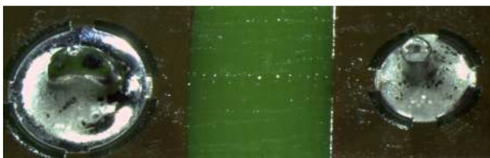
Figura 42 - Menisco formado no condensador eletrolítico.
