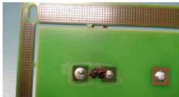
Figura 34 - Termopar colocado na superfície inferior da placa de circuito impresso.
