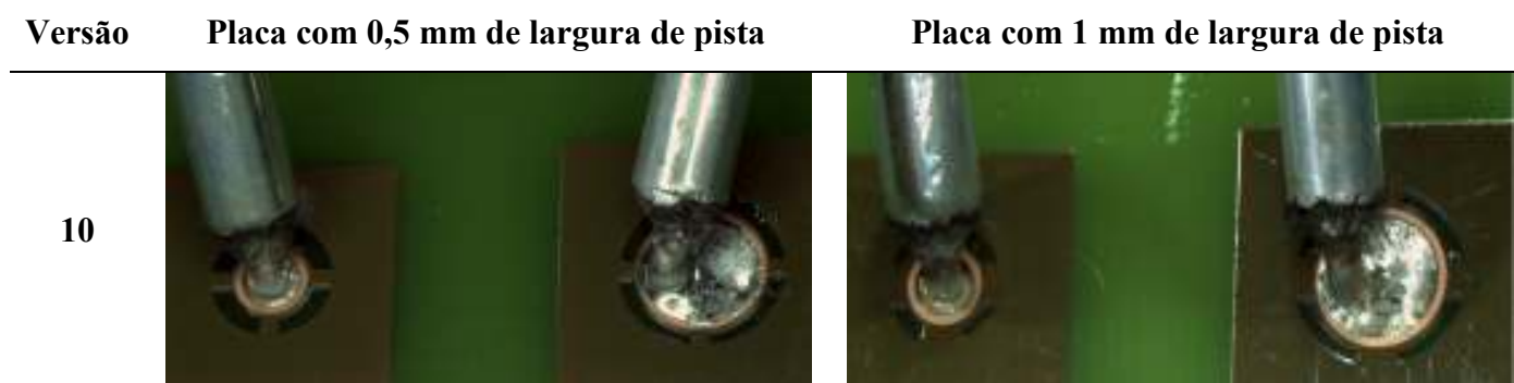
Figura 45 - Inspeção através de microscópio ótico realizada nos condensadores electrolíticos.
