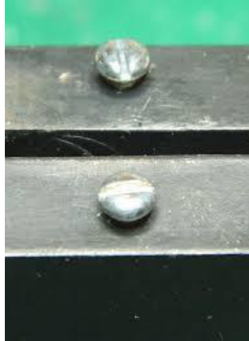
Figura 4.1 Parafusos mal "sentados"
