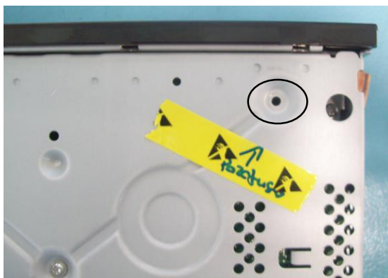
Figura 4.4 Peça apertada com parafuso a menos
