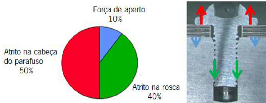
Figura 3.4 Fatores que intervêm na relação entre binário e pré-carga, em forma de gráfico e em representação real (Delphi E&S, 2005)
