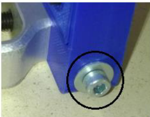
Figura 5.33 Ligação aparafusada entre “braçadeira” e caixa
