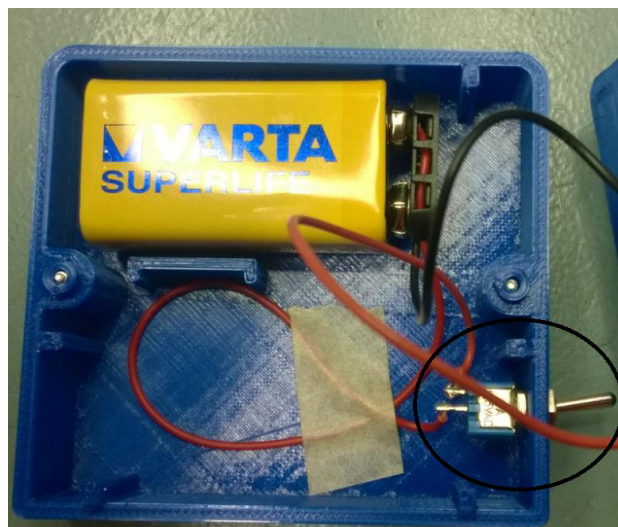
Figura 5.50 Pilha fixa com adesivo e furos para o interruptor
