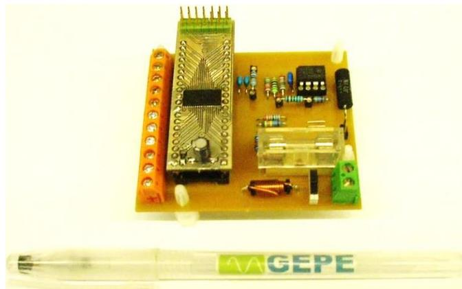
Figura 5.18 – PCB desenvolvida para o controlo, aquisição e comunicação de cada secundário do conversor CC-CC.
