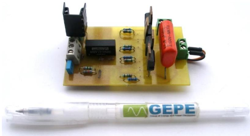
Figura 5.10 – Circuito de acionamento e ponte H do lado primário.
