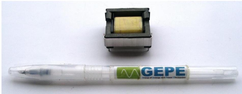
Figura 5.4 – Aspeto final do transformador de alta frequência desenvolvido.
