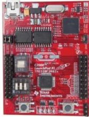
Figura 5.6 – Placa de desenvolvimento *C2000 Piccolo Launchpad* [54].
