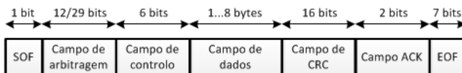
Figura 5.26 – Estrutura e número de bits de uma trama de dados ( data frames ) no protocolo de comunicação CAN.
