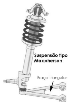
A7 VII - Representação da estrutura MacPherson (YouWheel, 2014).
