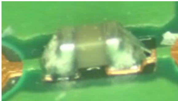
Figura 64: Soldadura de condensador 0402
