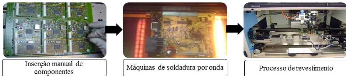
Figura 13: Processo de Montagem Manual
