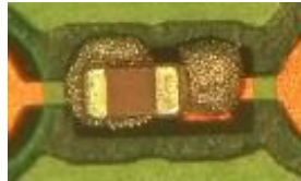
Figura 40: Descentramento do Componente
