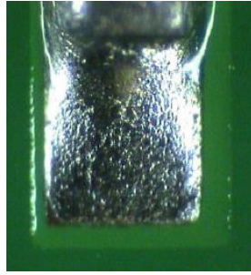
Figura 49: Exemplo de Soldadura Lead Free
