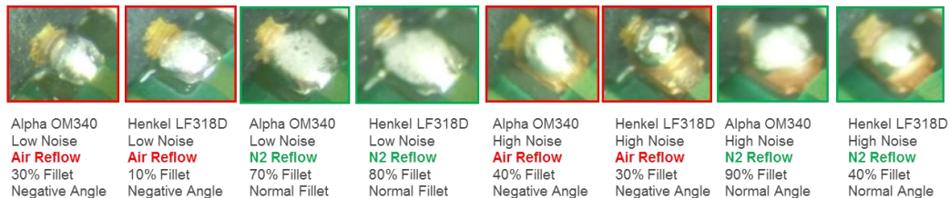
Figura 60: Soldadura QFN – relação entre fatores
