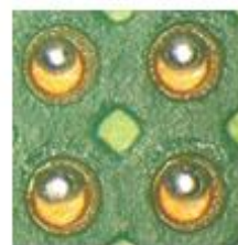
Figura 45: Coalescência da Solda
