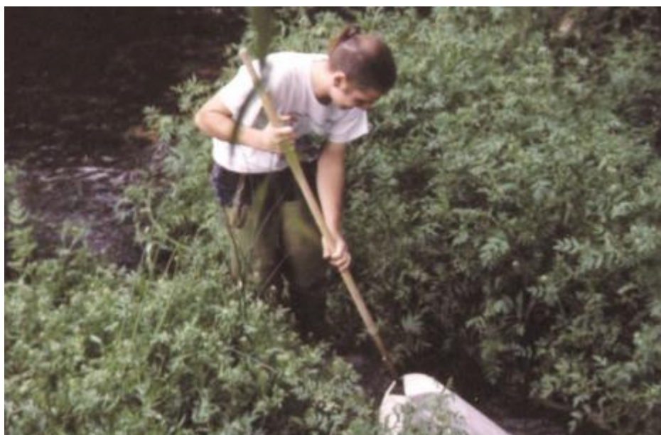
Figura 2 – Amostragem de macroinvertebrados com recurso ao método de rede de mão (Pascoal & Caseiro, 2001).
