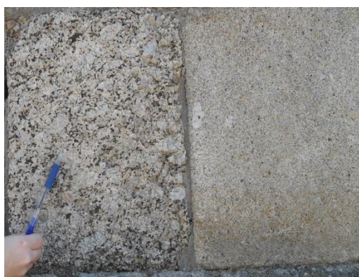
Figura 3: Granito de grão grosseiro do lado esquerdo e granito de grão fino do lado direito. Foto retirada da fachada da Igreja Nossa Senhora da Oliveira.
