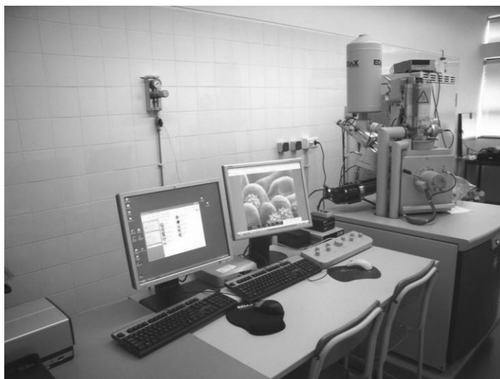
Figura 2.10 Sistema de microscopia electrónica de varrimento com sistema integrado de microanálise por raios X.
